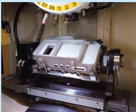
使用DDR-TiB分度加工零件
