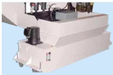
切削液装置 (水槽部分)
